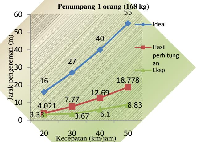
Gambar 10. Perbandingan grafik jarak pengereman ideal, hasil perhitungan dan hasil eksperimen pada jalan beton pada penumpang 1 orang
